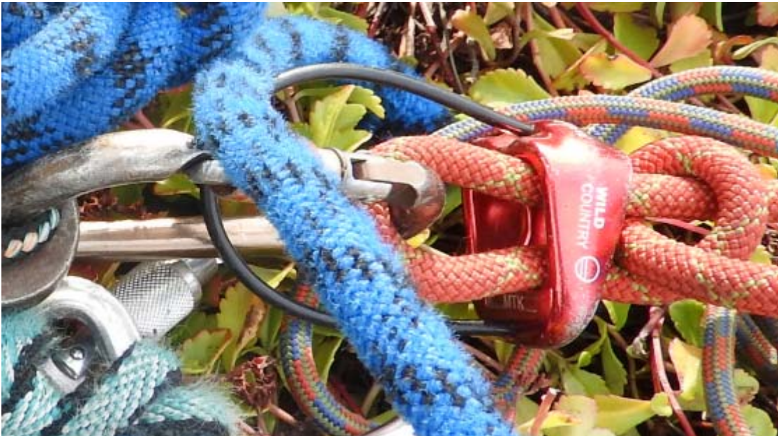
DSCN1441.jpg - Image de la corde rouge et de son ATC tout de suite après l'accident (la corde passe dans la même fente de l'ATC)
