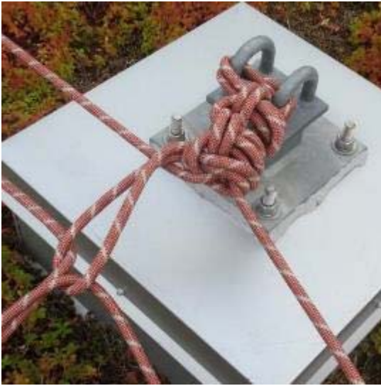
DSCN1502.jpg – Nœud difficile à inspecter par une tierce personne que celle qui l’a réalisé
