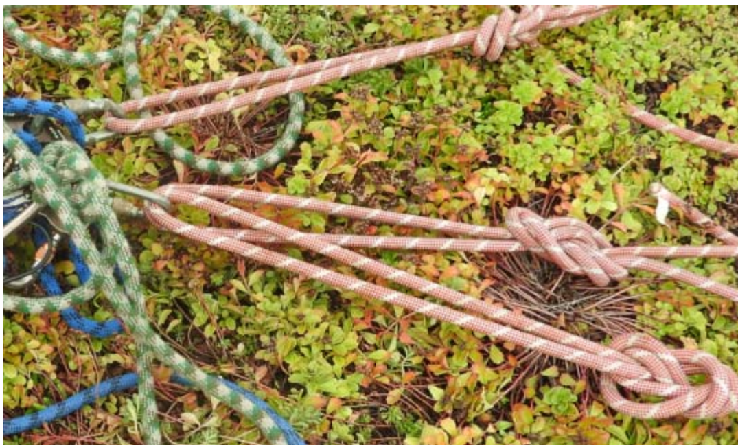
DSCN1430.jpg - Nœuds en 8 double sur les cordes d'ancrages ne sont pas convenablement dressés et serrés
