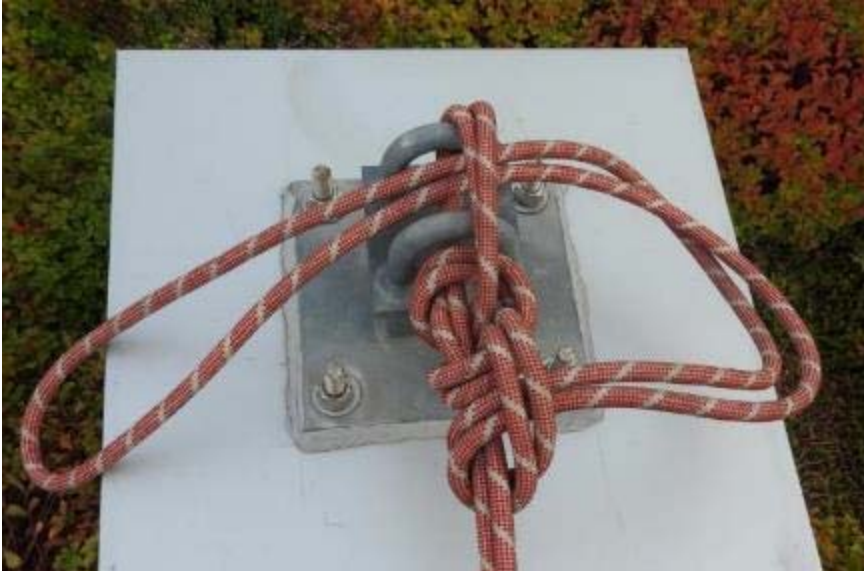
DSCN1505.jpg – Nœud difficile à inspecter par une tierce personne que celle qui l’a réalisé
