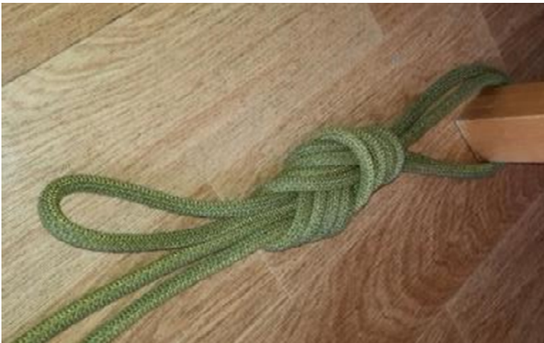
Photo prise par [ P ] – Démonstration d’un nœud d’ancrage solide et facile à inspecter qui pourrait remplacer celui de la photo DSCN1505.jpg
