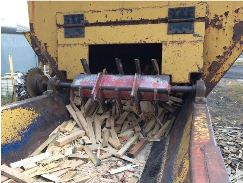
Figure 2 : Transporteur de bois et égaliseur sans protecteur d'engrenage Source : CNESST
