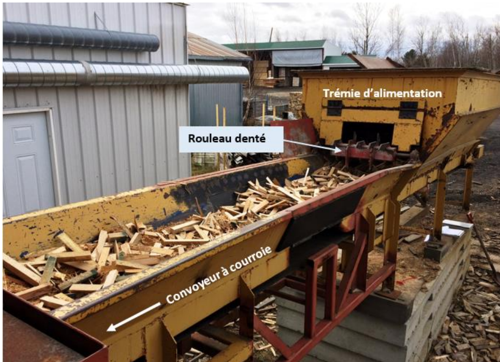
Photo 4 : Système d'alimentation du broyeur (vue surélevée en direction de la trémie d'alimentation) Source : CNESST
