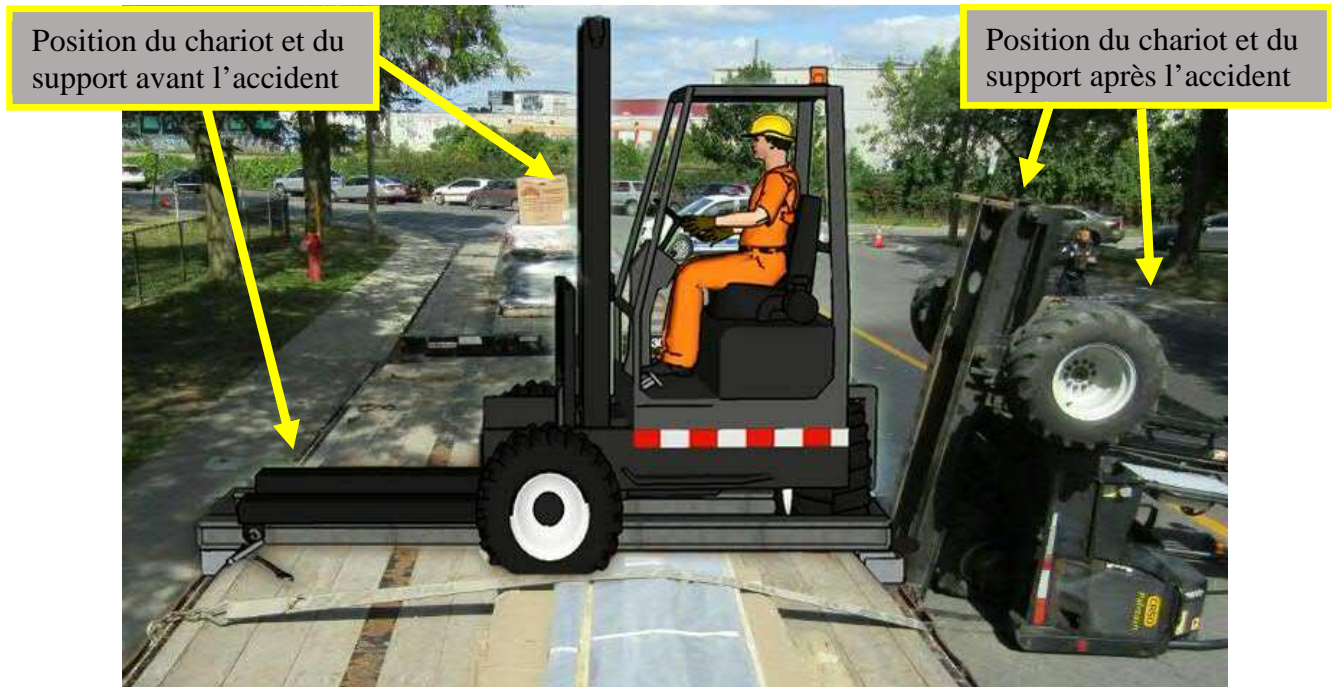
Figure 6 : Positions du chariot élévateur et du support avant et après l'accident (source : CNESST)
