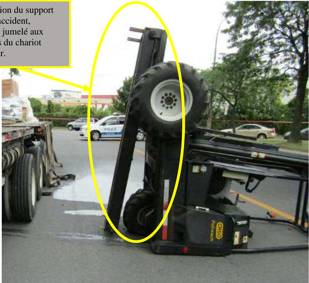
Photo 7 : Support embarque chariot après le renversement (source : CNESST)
