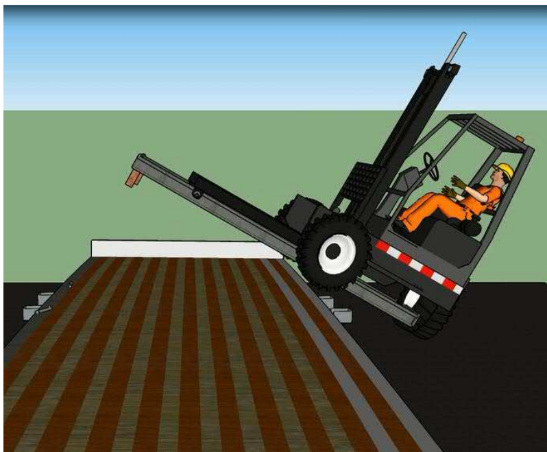
Figure 2: Illustration du renversement du chariot élévateur de la remorque (source : CNESST)
