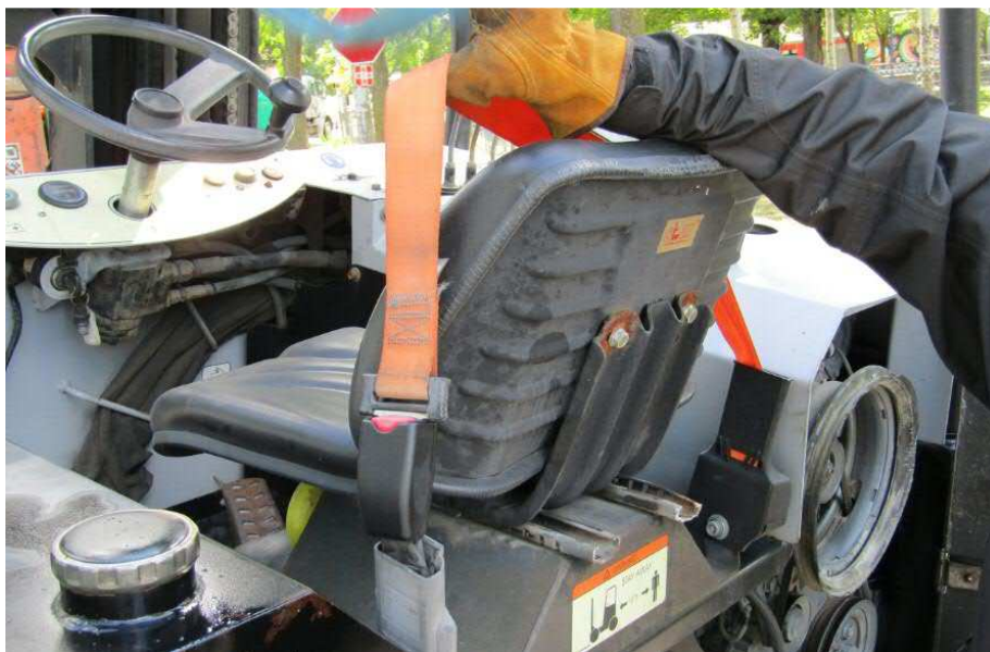
Photo 13 : Ceinture de sécurité sur le chariot élévateur (source : CNESST)
