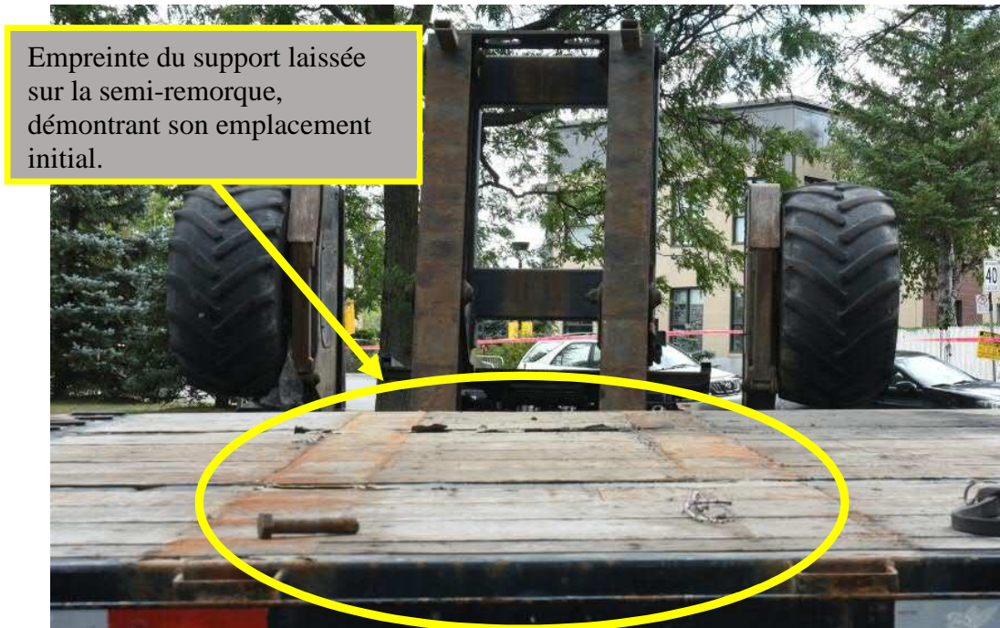
Photo 8 : Empreinte du support embarque chariot (source CNESST)
