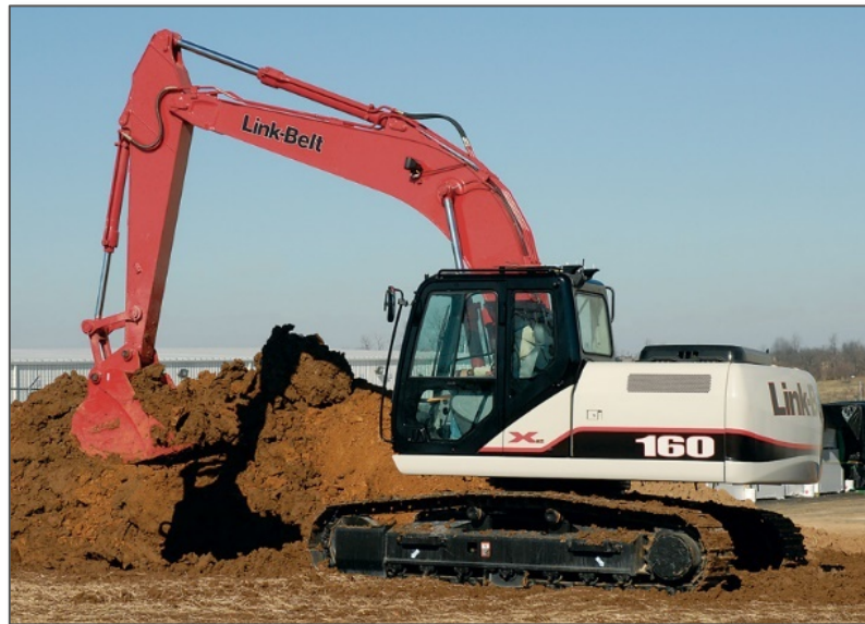
Photo 8 : Pelle mécanique de marque Link-Belt, modèle 160 x2 Source : https://www.lbxco.com/160X2.asp
