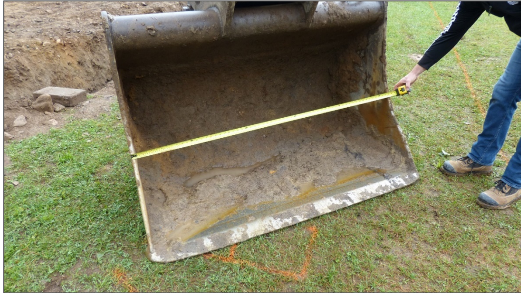
Photo 6 : Godet de la pelle impliqué dans l'accident Source : CNESST
