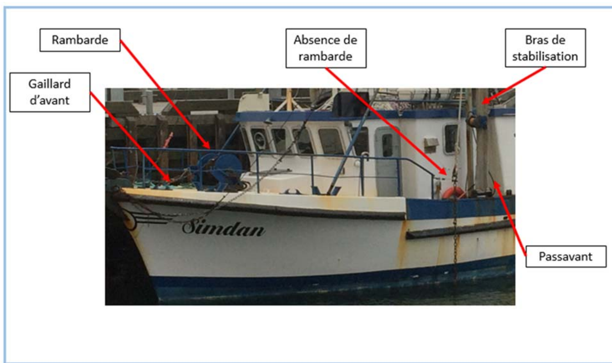
Photo 4 – Rambarde du gaillard d'avant côté bâbord (source : CNESST)
