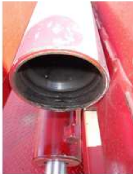
Photographie 11 : Cylindre supérieur sur le camion avant le démontage
