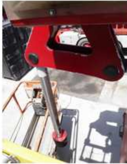
Photographie 10 : Pivot en T et tige du vérin avant démontage
