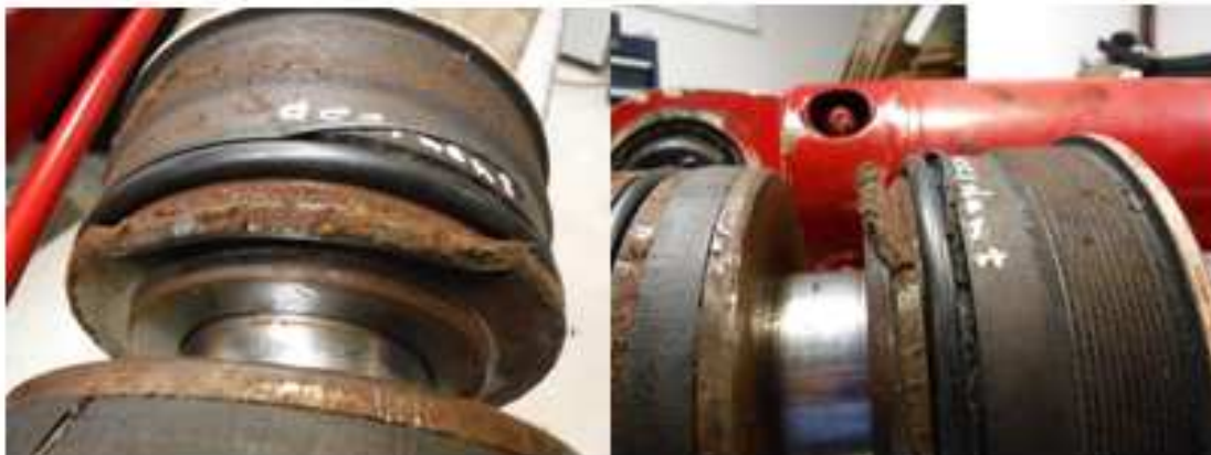
Photographie 4 : Plaque corrodée retenant le joint de la tête de cylindre
