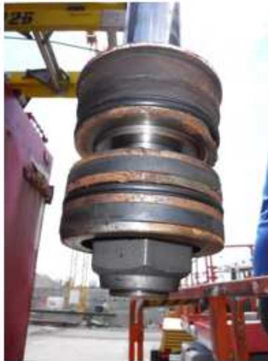
Photographie 12 : Fixon et tête sur la tige avant démontage
