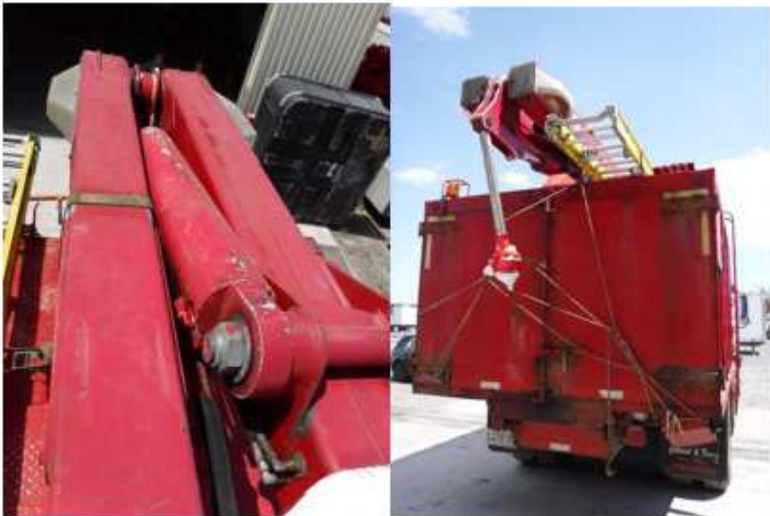
Photographie 3 : Position du cylindre et de la tige pour le déplacement
