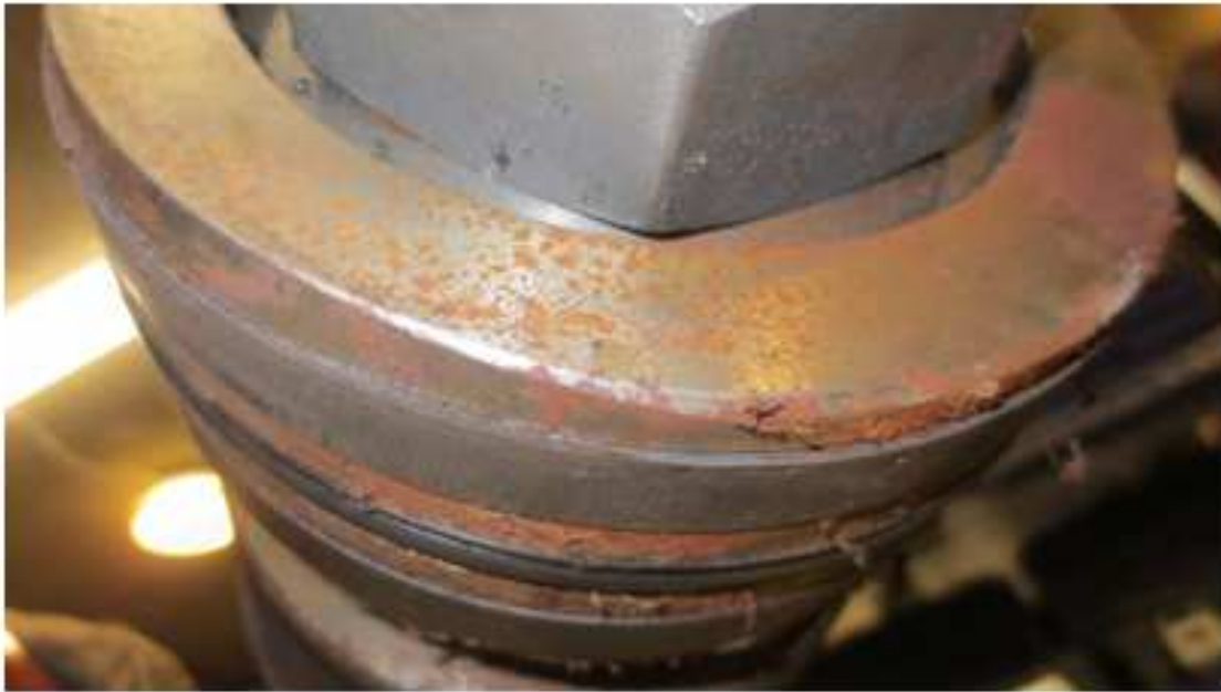
Photographie 14 : Surface usée par l'accident sur le piston
