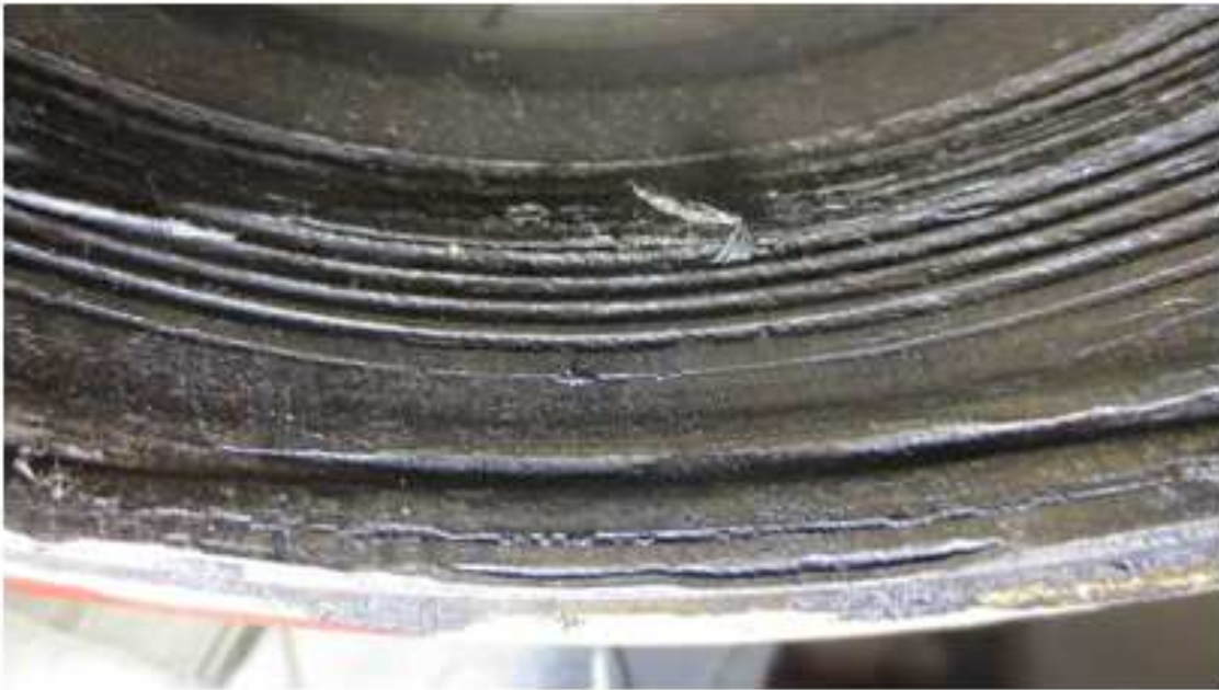
Photographie 5 : Filets du cylindre quasiment lisses
