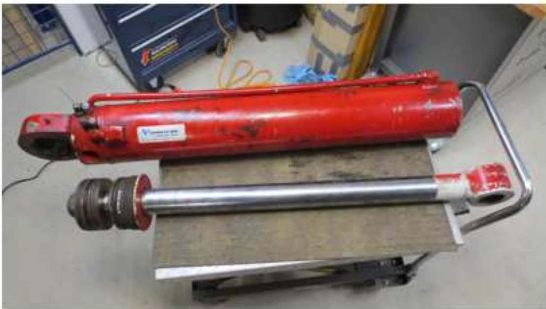
Photographie 17 : Cylindre et tige avec piston et tête
