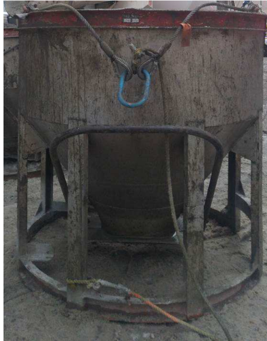
Photo 4 : Benne à béton de 5 tonnes Source : CNESST
