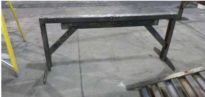
Photo 5 : Tréteau métallique Source : CNESST
