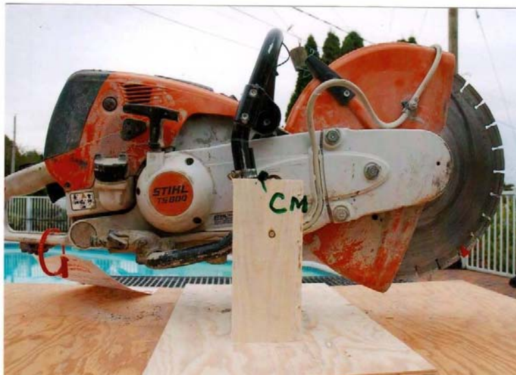
Figure 3 : Photographies montrant, de profil, la découpeuse Stihl TS800 concernée. Cette découpeuse possède une masse globale de 16,6 kilos et est munie d'une disque au diamant de 400 mm de diamètre. Le centre de masse CM est localisé au niveau du cadre central de l'appareil servant de poignée.
