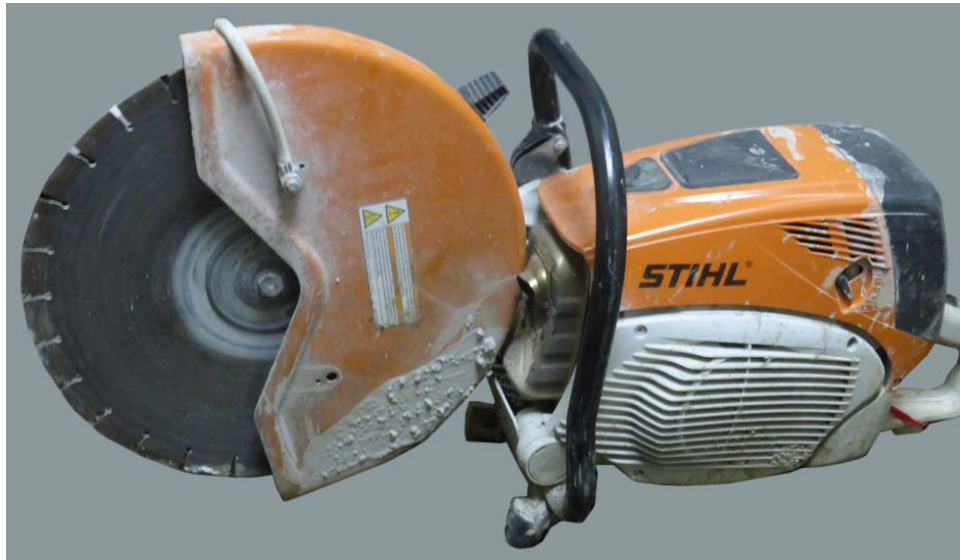
Photo 4 : Découpeuse à disque STIHL TS800 Source : CNESST
