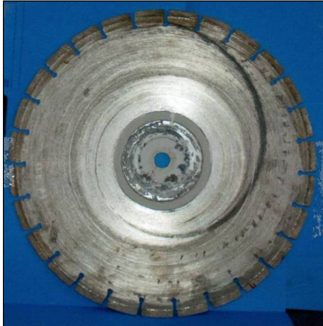
Photo 6 : Empreinte sur le côté du disque Source : Rapport Expertech
