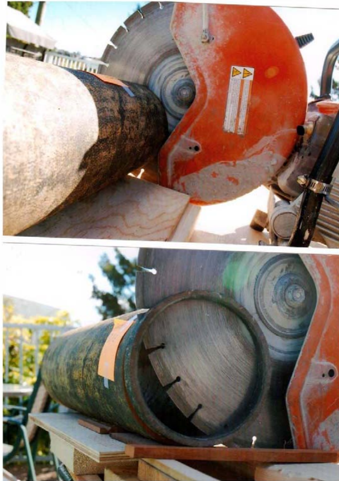
Figure 5 : Photographies montrant, sous deux angles différents, les positions du disque de la découpeuse et d'un segment de tuyau requises pour couper la partie la plus basse de la pièce évidée tout en maintenant la découpeuse à l'horizontale. On note que le disque doit entrer très profondément dans le tuyau pour atteindre cette partie.
